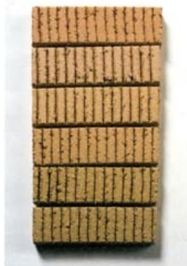
右:当時、一番困難だったのが焼成。職人たちは色を出すのに試行錯誤を続けたという。現在は10℃ごとに差をつけて焼いたテストピースで、最適な色を決めて焼成する。
